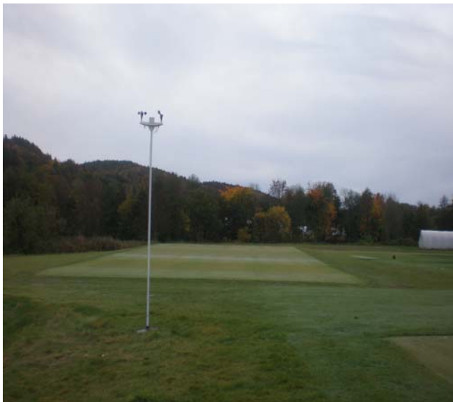
Bilde 2. Automatisk værstasjon fra Rainbird Irrigation Company montert ved siden av forsøksgreenen på Landvik. Foto: Trygve S. Aamlid
