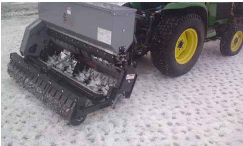
Denne maskinen er populær ikke bare som såmaskin. De kraftige, vibrerende pinnene kan knuse is. Foto: Tor Mjøen
