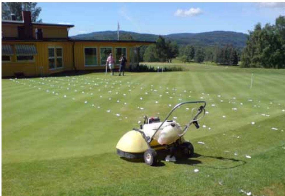
Skummarkør brukes for å unngå overlapping ved sprøyting. Foto:Terje Haugen
