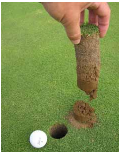
Sand som drysser fra jordprofilen er et tegn på at jorda er hydrofob.
