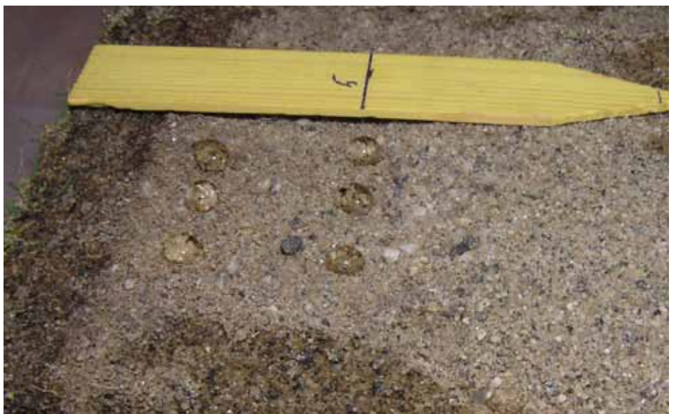
Graden av hydrofobisitet bestemmer ved å måle hvor mange sekunder /minutter dråpen blir liggende.
