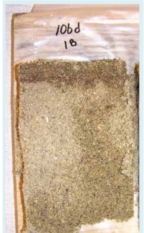
Finger flow» fører vann med næringsstoffer og plantevernmidler ned gjennom en hydrofob vekstmasse. Dette gir ujevne greener og økt miljøbelastning.
