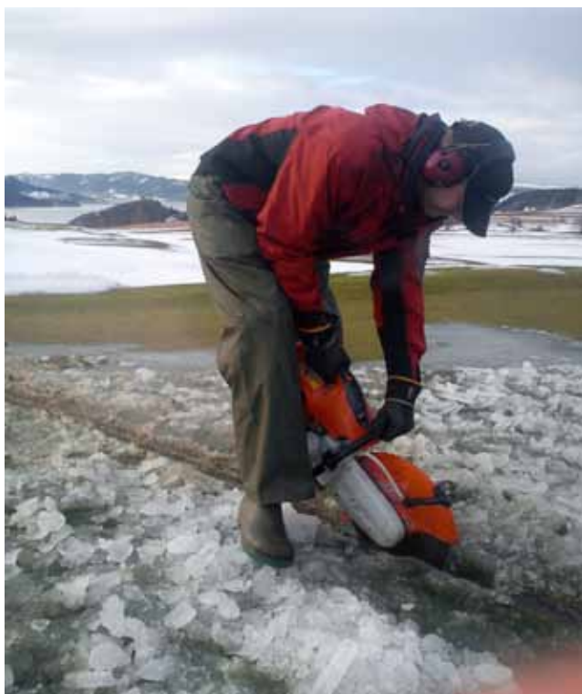
En asfaltsskärare kan användas för att göra dräneringsdiken på istäckta greener. Foto: Ole Albert Kjosnes, Byneset golf.
