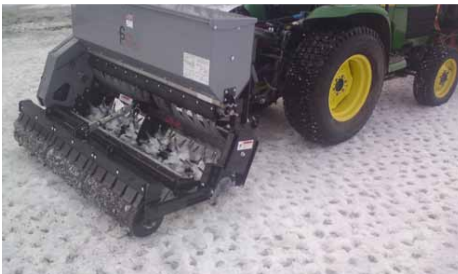
Denna maskin har blivit populär inte enbart som såmaskin. De kraftiga, vibrerande pinnarna kan krossa is. Foto: Tor Mjøen
