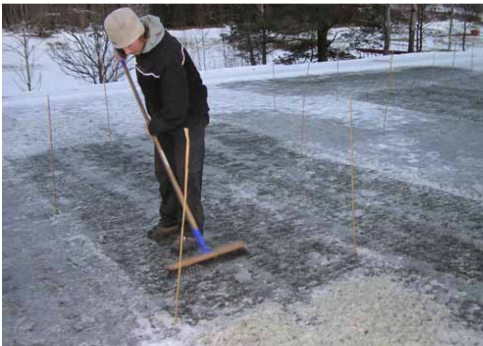
Denna is blev borttagen i ett experiment. Den ljusgröna färgen på den krossade isen indikerar på ett korrekt arbetsdjup. Foto: Agnar Kvalbein, Bærum GK, februar 2008.
