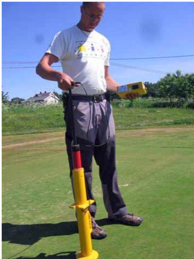
Bilde 3. Måling av overflatehardhet med Clegg Impact Hammer
