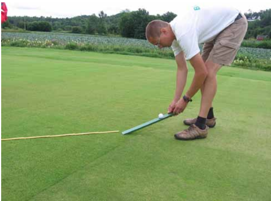
Bilde 4. Måling av ballrull med kort stimpmeter. Engkvein ga tregere greener. Foto: Tatsiana Espevig.
