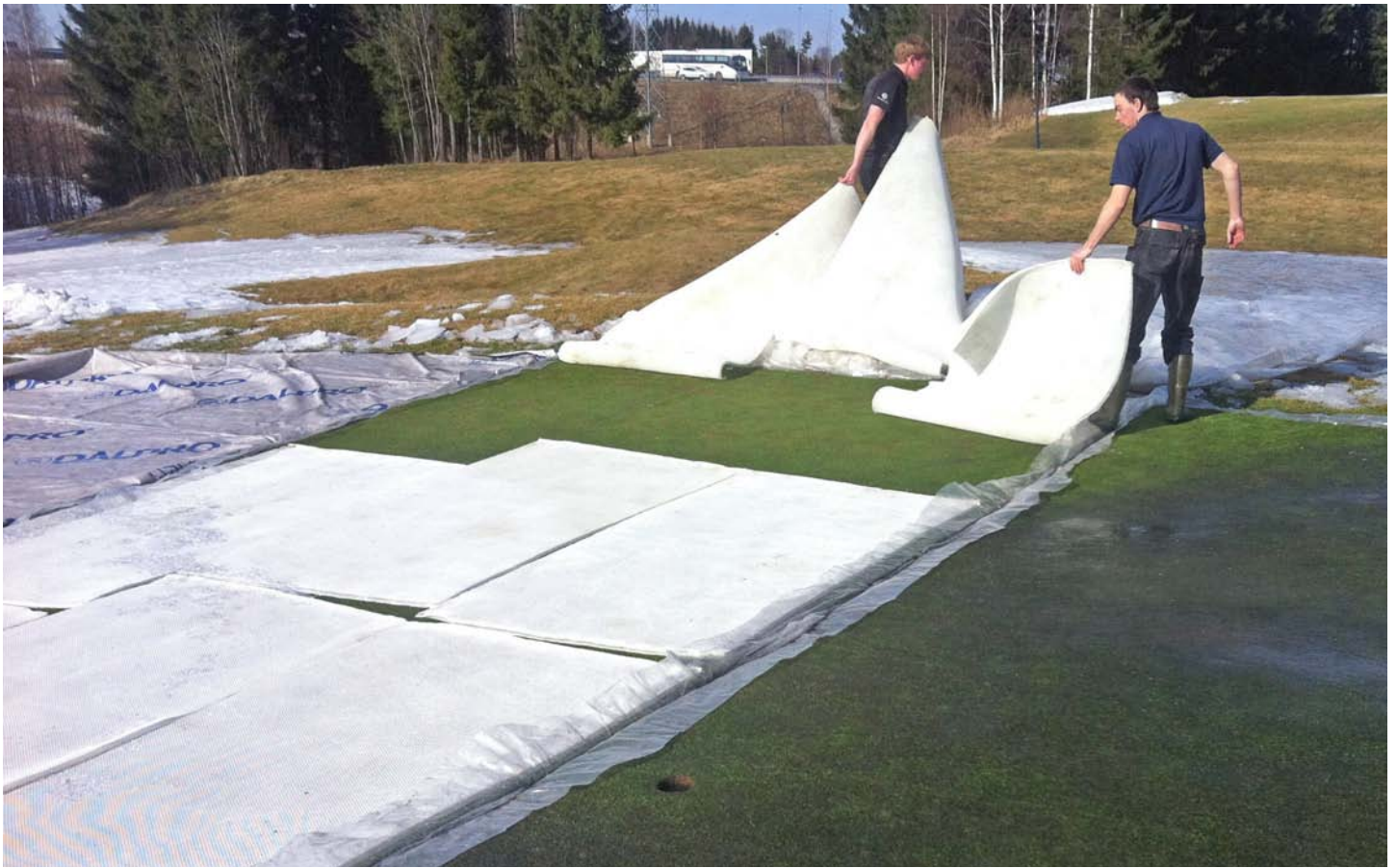
Et spesiell tekstil ble bruk til å lage luftlag (18 mm) mellom plast og gressmatta. Her blir den fjernet fra et demonstrasjonsforsøk på Miklagard golfbane i Norge. Til venstre ser du en semi-permeabel duk. Til høyre lå det bare plast. Foto: Stefan Schön.
