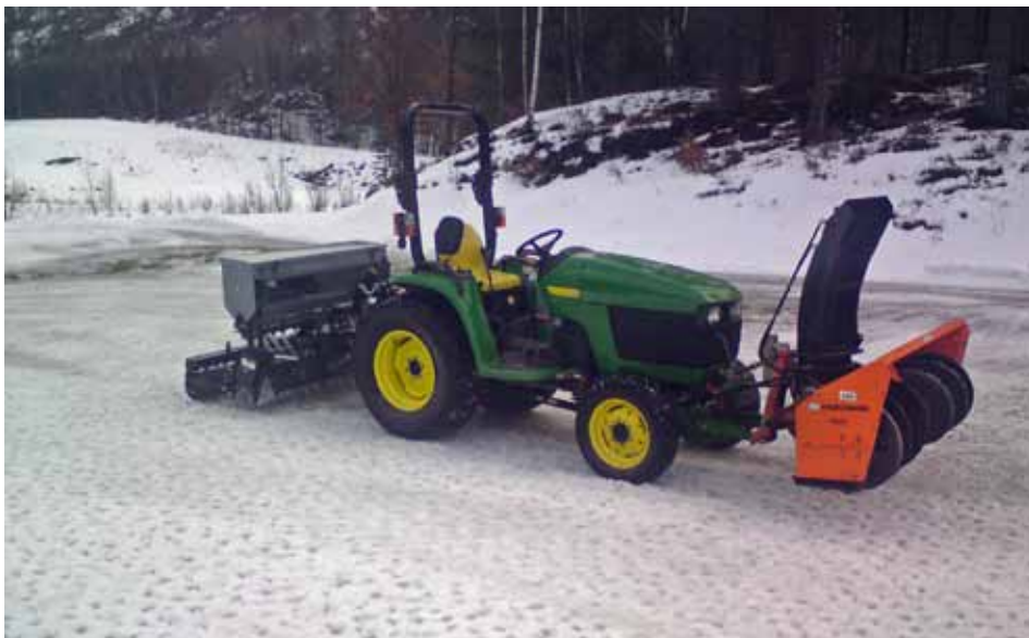
Frontmonterad snöslunga, här i kombination med en vibrerande luftare som passar för krossning av is. Foto: A. Kvalbein.
