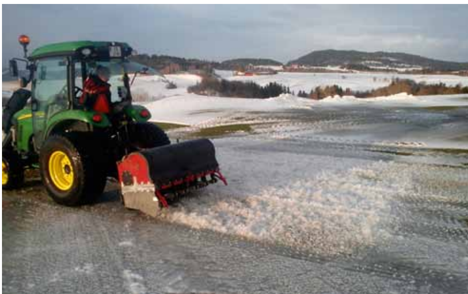
En gammal luftare blir använd till att krossa is på en golfbana i Trondheim, Norge, där is ger stora utmaningar nästan varje vinter. Foto: Ole Albert Kjøsnæs.
