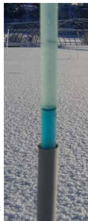
Figur 1. Kombinerad utrustning för mätning av snötäcke och tjäle kan tillverkas och sättas upp som visas i denna illustration. Foto: Trond Pettersen
