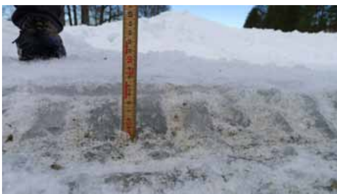
Under snötäcket hade 7 cm solid is bildats på greenytan. Is med en hög andel luftporer är vit. Solid is är transparent. Foto: A. Kvalbein
