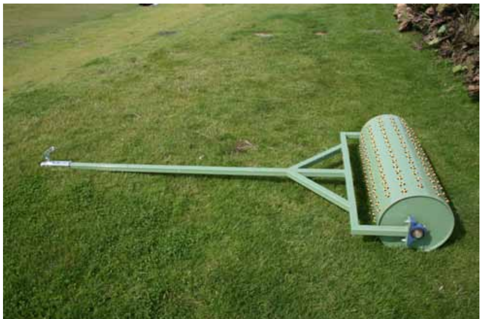
Bild 2. Slitagevält som används i försöket på Sydsjælland GK. Foto: Anne Mette Dahl Jensen
