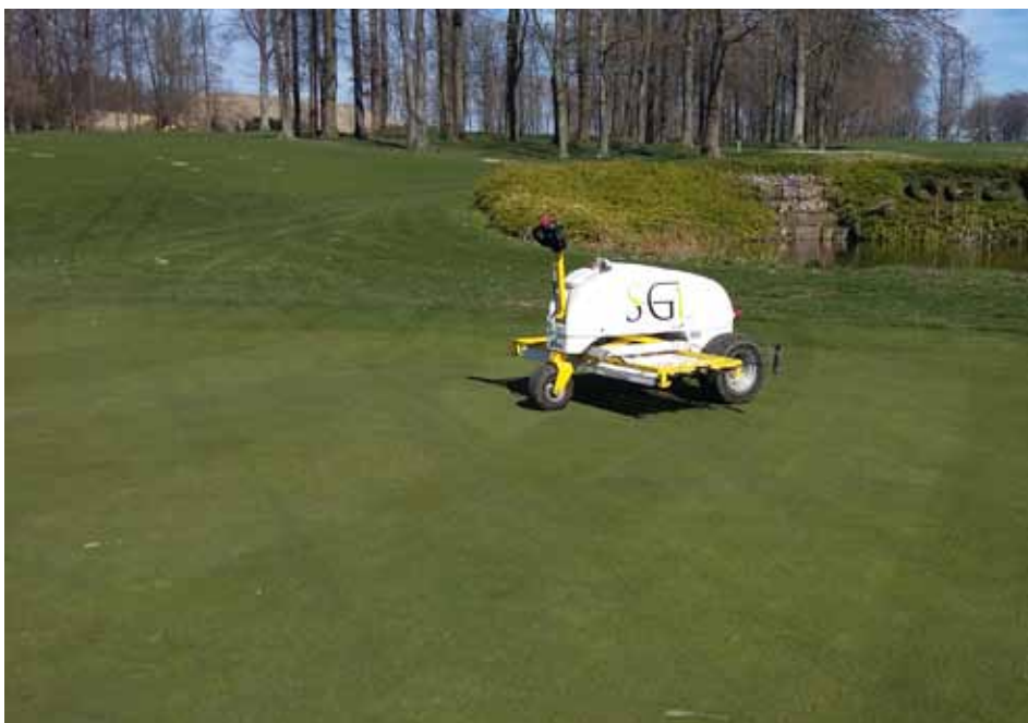
UV strålning mot grässjukdomar testas i IPM-golfprojektet på Köpenhamns GK. Foto: Wolfgang Prämässing
