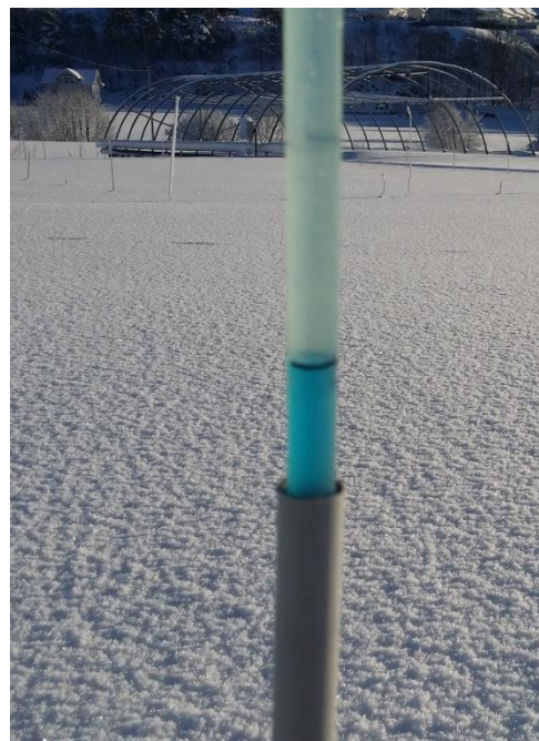
Kuvio 1. Yhdistetty routa ja lumensyvyysmittari voidaan tehdä ja asentaa kuten tässä kuvassa. Kuva: T.O.Pettersen.
