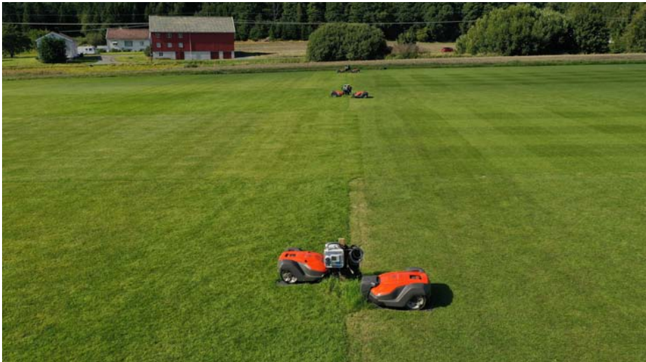
Foto 4: Dronefoto fra Landvik som viser forsøksareal med fairway til høyre og semi-rough til venstre. Annenhver storrute klippes med robot og annenhver storrute med vanlig manuell klipper. Foto: Karin J. Hesselsøe.
