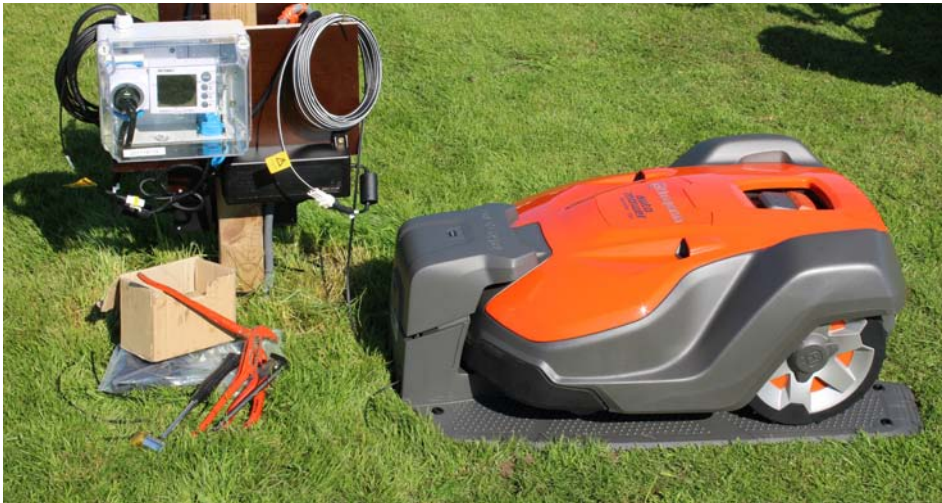
Foto 3: Klipprobotarna i ROBO-GOLF projektet. Vid varje laddstation är det installerat en logg som mäter energiförbrukningen. Foto: Anne F. Borchert.
