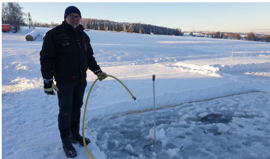
Bilde 2. Forskingstekniker Jan Tangsveen etablerer isdekke i ledd 3, 5.januar 2021. Han gjorde et første forsøk på å legge is 30.november og gjentok dette flere ganger i desember, men fram til årsskiftet var det så mildt at det bare ble 'slush' på rutene. Den 5.januar var det endelig blitt kalt, men på grunn av 'slushen' på rutene blir isen ganske porøs. Foto: Marte Skattebu.
