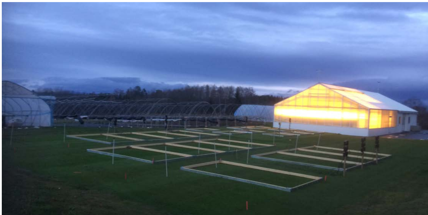
Bilde 1. Forsøksgreenen på Apelsvoll 25.nov. 2020., klar for vinteren. Behandlingsruter der det skal etableres isdekke gjennom hele eller deler av vinteren er omgitt av rammer. Hvite plaststenger inneholder rør fylt med metylenblått for måling av tele i bakken, og de sorte veskene som er festet til trepålene inneholder sendere for temperatur og gass-sensorene som er nedgravd like under overflaten på mange av rutene. Foto: Trygve S. Aamlid
