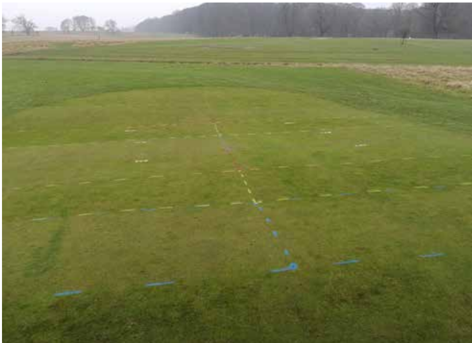
Foto 3: Översikt över försöket på inspelningsgreenen på Köpenhamn GK, december 2020. Blå vältades fyra gånger per vecka, röda - två och gula - noll (kontroll). Foto: Martin Nilsson.
