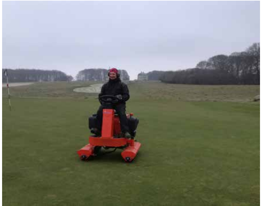
Foto 1: Markeringskoste, som normalt anvendes på fodboldbaner, blev banket godt ned i greenen og fungerede som fixpunkter for hvor og hvor ofte tromlen skulle køre på indspilsgreenen. Foto: Martin Nilsson, Juni 2020. Foto 2: Tromling med greenstromle i KGK. Foto: Karin Juul Hesselsøe.
