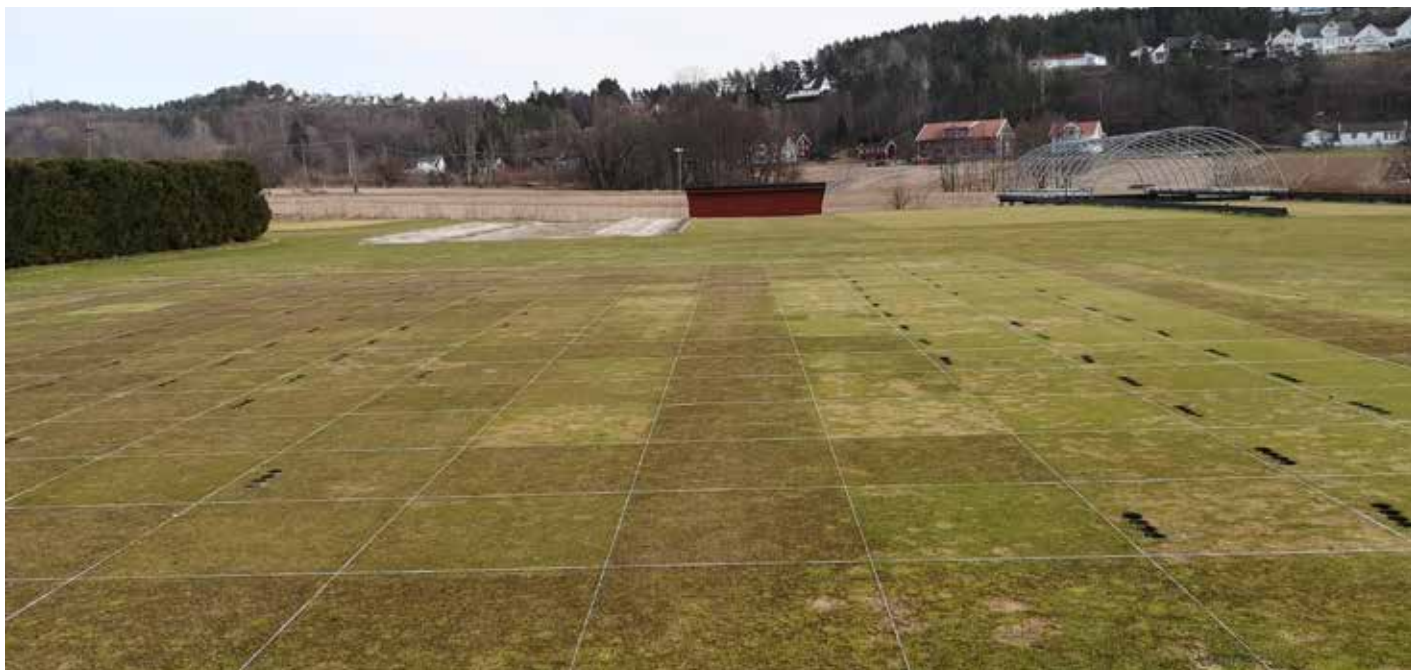
Bilde 1: Utsnitt av SCANGREEN på Landvik i februar 2022. Grenserad med rein rødsvingel i midten, rad med blandinger med klipt på 5 mm og gjødslet med 11 g N/m 2 til venstre for grenseraden og rad med de samme blandinger klipt på 3 mm og gjødslet med 17 g N/m 2 til høyre for grenseraden. Rutene med mest mikrodochiumflekk er krypkvein + raigras. Radene lengst til venstre og høyre i bildet er ordinær sortsprøving av henholdsvis rødsvingel og krypkvein. Foto: Karin J. Hesselsøe.
